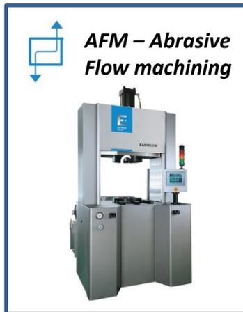
*...Material wird durch abrasiven Mediumfluss entfernt, welcher durch einen unter Druck stehendem hochviskosem Medium kreiert wird*
