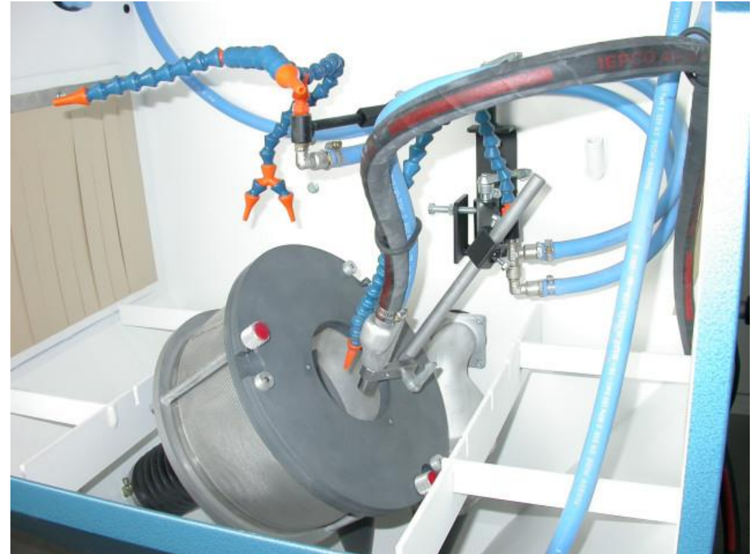
Strahlkorb in einer Strahlanlage [Quelle: MST-reutlingen ]
