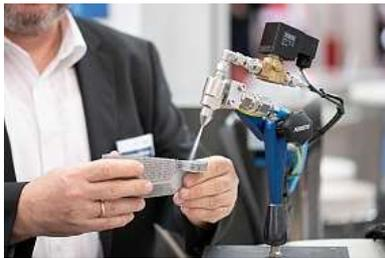
Die Nachbearbeitung additiv gefertigter Metallkomponenten stellt nach wie vor eine Herausforderung dar. Der Themenpark AM Parts Finishing präsentiert automatisierte Lösungen; die ein reproduzierbares Ergebnis sicherstellen.
