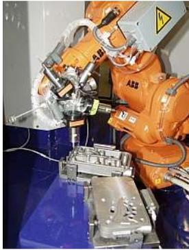
Im Zuge fortschreitender Automatisierung und Digitalisierung gewinnt das automatisierte Entgraten mit Industrieroboter an Bedeutung. Die Möglichkeiten der Roboter automatisierten Oberflächenbearbeitung bildet der Themenpark komplett ab.
