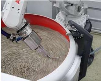
Innovative Lösungen in der Automatisierungstechnik ermöglichen, klassische Verfahren wie das Gleitschleifen für neue Anwendungen auch in Einzelteilbearbeitung automatisiert einzusetzen.
