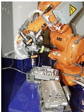
Dans le cadre de l'automatisation et de la numérisation, l'ébarbage automatisé avec des robots industriels gagne en importance. Le parc à thème « L'ébarbage automatisé avec des robots industriels » offre une gamme complète de possibilités.
